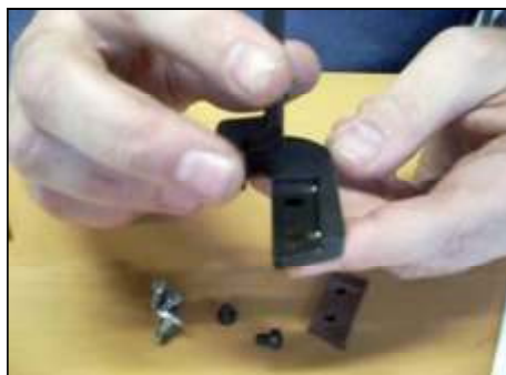
Figura 10: tornillos prisioneros para fijar la cuchilla inferior
