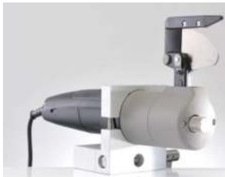
Figura 3: cortador con bloque tensor
