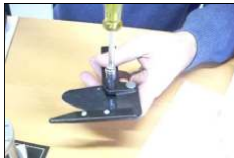
Figura 12: Quitar/colocar el tornillo de cabeza hueca hexagonal
